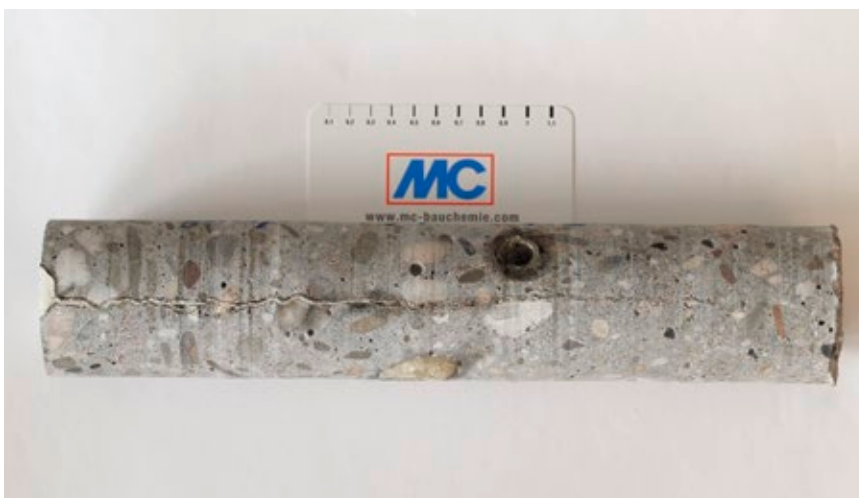
Der Schnitt durch ein injiziertes Bauteil zeigt deutlich die Eindringtiefe von MC-Injekt 2133 flex bis in die feinsten Haarrisse
